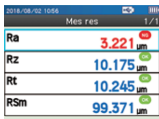
Példa: mérési eredmény elfogadhatóságának (OK/NG) megítélése
