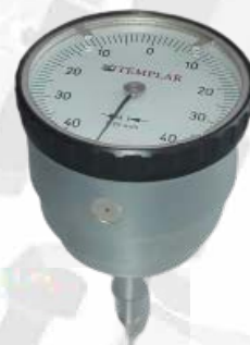
Mérőóra horizontális számlappal Templar M.S. 3/0,01 mm (számlap átmérője 58mm )
