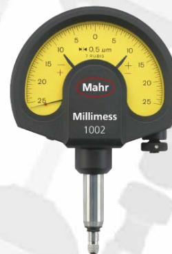
Finomkijelzős mérőóra Mahr Millimess 1002 +/-25um/0,5um
